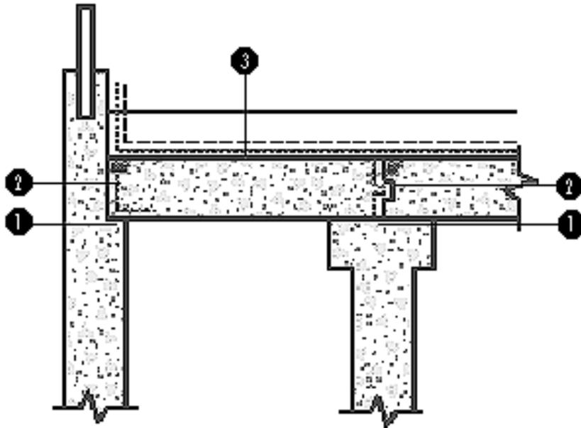
1. **JUNTAS.** Aplique una capa de lechada de XYPEX CONCENTRADO en una proporción de 3 partes de polvo por 1 parte de agua a todas las superficies de las juntas constructivas entre los vaciado del concreto.
